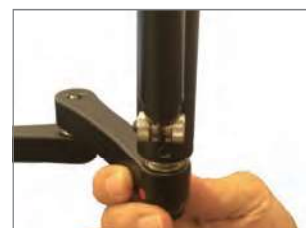
スプリングのテンションでアシスト力を調整
